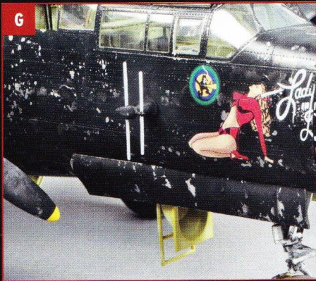
G. L'accès au poste de pilotage et du mitrailleur avant se faisait au moyen d'une trappe équipée d'une échelle placée dans le puits du train avant. Le garde-boue installé sur la roue avant évitait les projections dans ce logement encombré de nombreux câbles et autres durits, évitant ainsi des travaux de maintenance supplémentaires.
